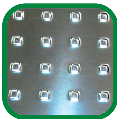
Rebrasta pločevina s kvadratnimi izboklinami
